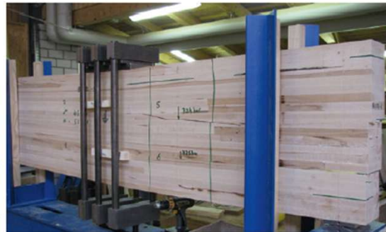
Im hausinternen Labor werden die Produkteigenschaften ganzer Leimbinder (Bild: BSH-Buche, GL48k) oder einzelner Lamellen überprüft und verbessert
